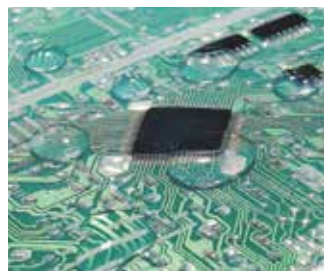
Schede elettroniche verniciate con un "film" silconico.
